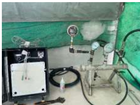
ภาพที่ 2-18 การทดสอบการรั่วไหลของท่อด้วยวิธีการทดสอบแบบอัดอากาศ (Air Pressure Test)
